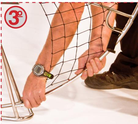
Fijar el clip que une la barra del chasis a la base del chasis.
