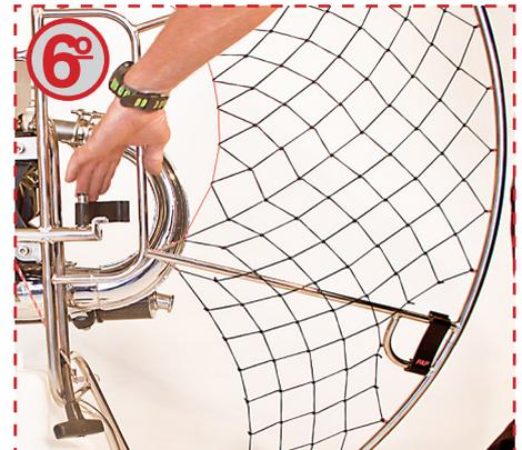
Fijar el clip de unión a la base del chasis.
