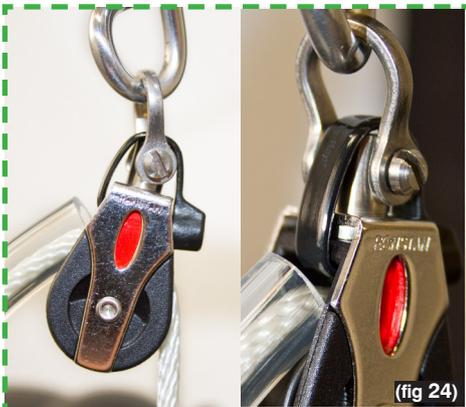
La presilla sirve para que el asa siempre quede posicionada hacia delante para que sea más fácil cogerla con el paramotor en la espalda.
